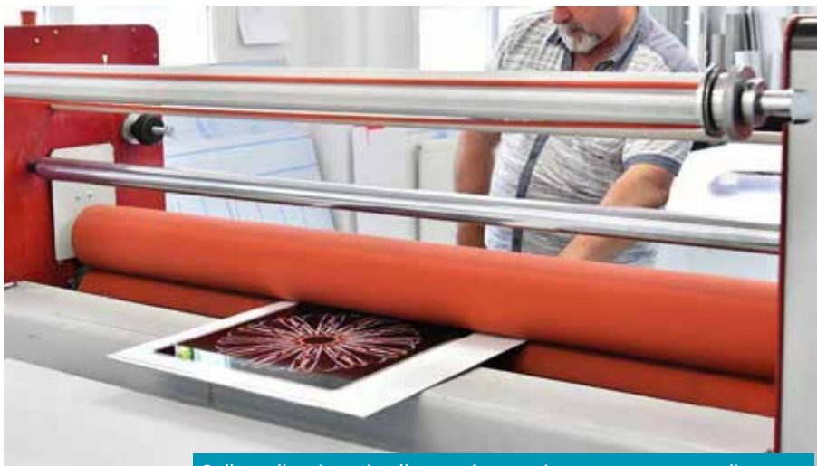
Collage d’un tirage jet d’encre pigmentaire sous un verre acrylique
